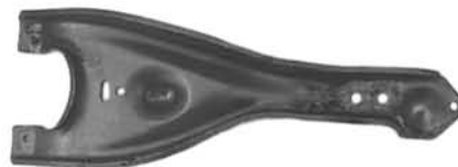
HC-AMC C/P 3224192 Rambler, Gremlin, Pacer (1964-1987) Jeep, Wagoneer, Cherokee (1976-1980) (con pernos para portacollarín)
