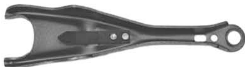
HC-D 100 3643998 Camioneta Dodge serie D 100 y D 300, hasta modelo 1979.
