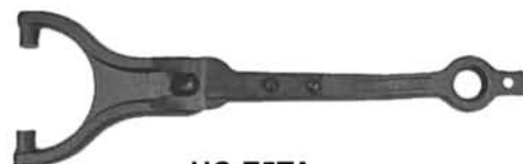
HC-Z5TA Z5TA-7515-A Camioneta Ford F 100, F 150 y F 350, modelos 1969 en adelante.
